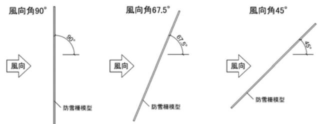
図 - 5 防雪柵模型設置平面図
