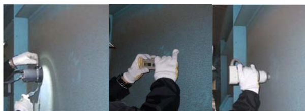
写真-6 各種計測状況 (左から、表面塩分計、光沢計、色彩色差計)
