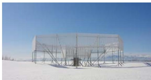
図 - 4 石狩吹雪実験場に設置した DFIR
