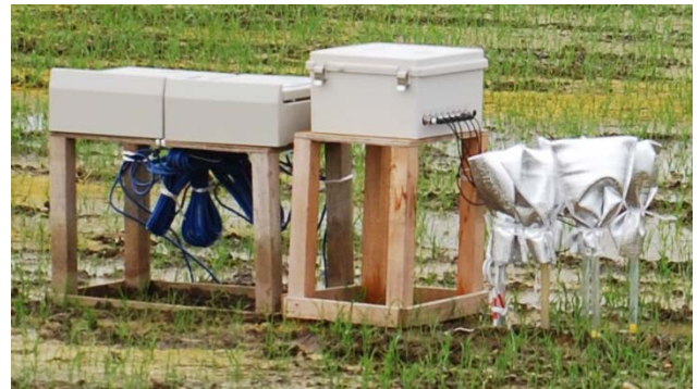
写真-3 テンシオメータ設置状況
