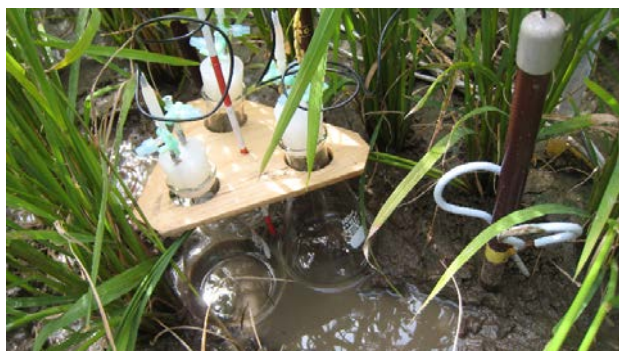
写真-5 土中水採取状況
