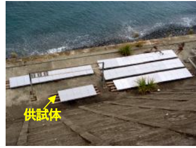
図-4.9 市振暴露場における表面被覆材の屋外暴露
