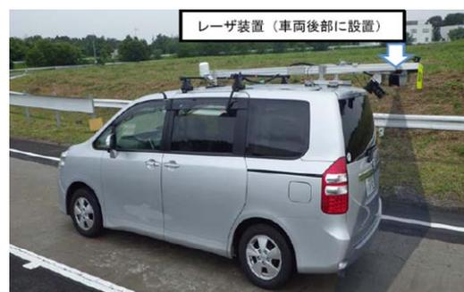
写真-10 測定車へ踏査したわだち掘れレーザ装置
