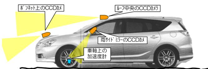
図-14 簡易測定車の装置構成例
