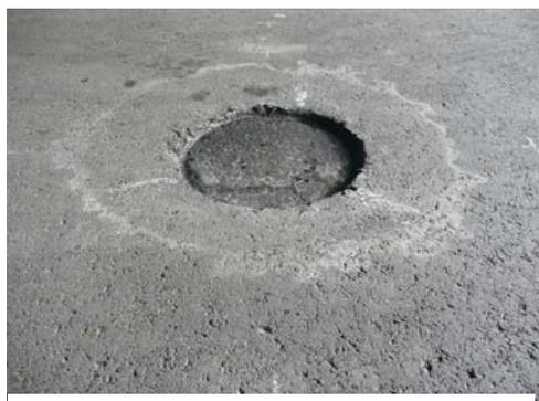
写真-3 約 102 百万回載荷時の路面状況
