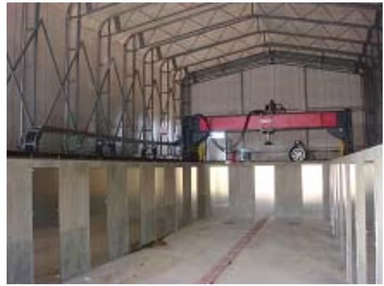
写真-1 繰返し载荷試験装置
