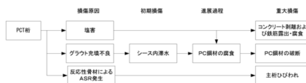
図-6 PCT桁橋の損傷の発生過程フロー図
