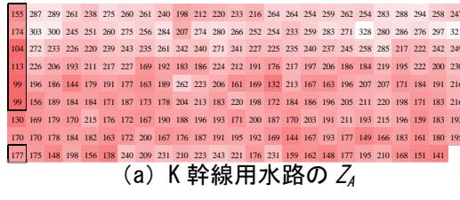
(a) K幹線用水路の  $Z_A$
