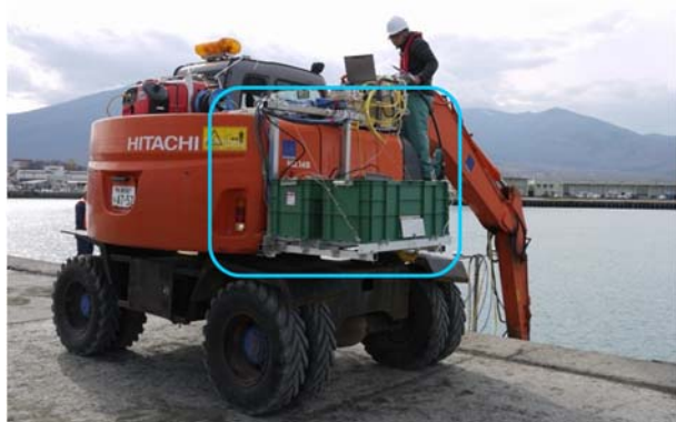
図-11 バックホウに取り付けた収納ボックスと収納ボックス取付台
