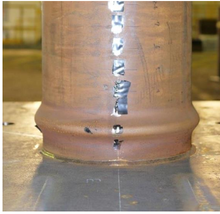
写真-6 実験終了時の座屈状況 (供試体 2-1)
