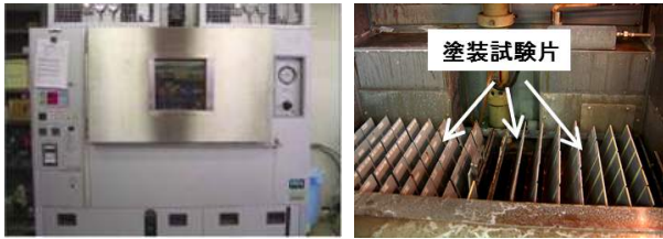
図-1 複合サイクル試験機によるサイクル腐食試験
