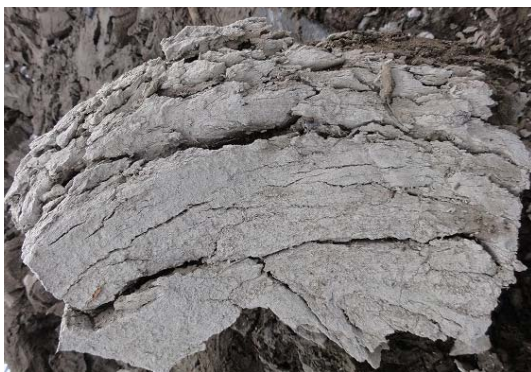
写真-10 大型土のう内の土砂に形成されたアイスレンズ
