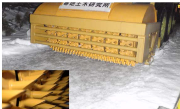
写真-2 雪氷路面処理装置の破碎部
