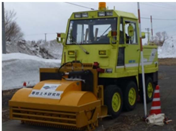
写真-1 装置の全景（小形除雪車装着）
