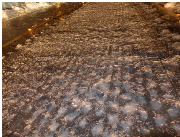
写真-7 雪氷路面処理装置走行後の路面状況
