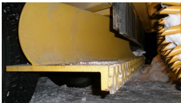
写真-3 雪氷路面処理装置の排雪部
