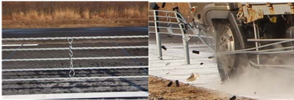
写真9 CASE3 (左: 連結材, 右: 衝突時の状況)
