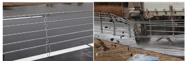
写真7 CASE1 (左: 連結材, 右: 衝突時の状況)
