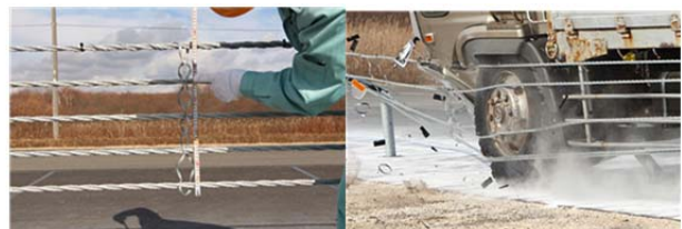
写真8 CASE2 (左: 連結材, 右: 衝突時の状況)
