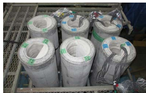
写真-3.1 既製RC杭模型の断面
