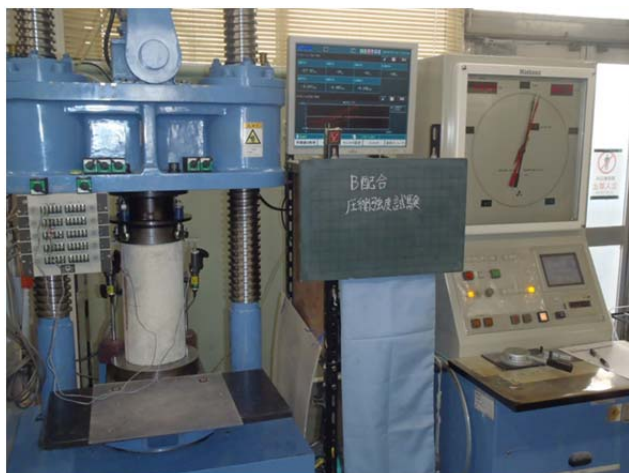
写真-4.2 圧縮強度試験状況
