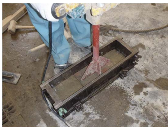
写真-4.1 供試体作製(タンパ締固め)状況
