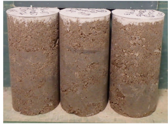
写真-4.3 配合試験供試体外観 (W90) : 配合 A
