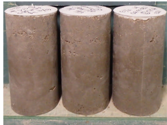
写真-4.4 配合試験供試体外観 (W100) : 配合 B
