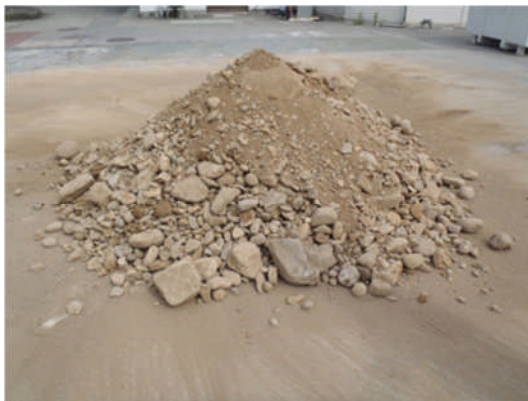
写真-4.1 試験用 CSG 材の分級前
