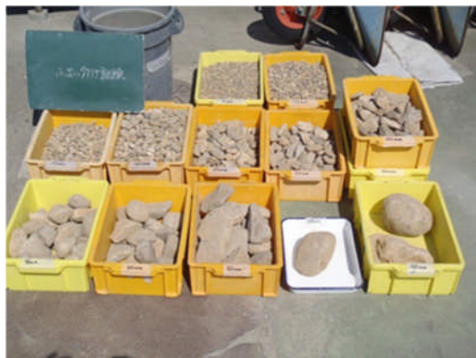
写真-4.2 試験用 CSG 材の分級後
