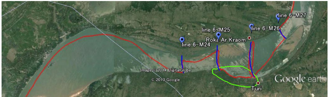
図-3-6 観測測線 M26 近辺のメコン川の平面形，曳航船の航跡（赤），観測測線（青）
