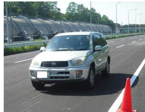
写真-2 情性走行試験（普通車）
