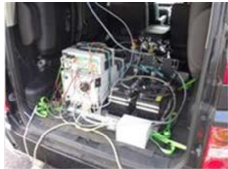
写真-4 排出ガス計測装置
