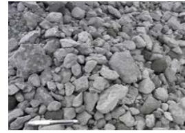
写真-1-2 焼却灰を利用した再生資材
