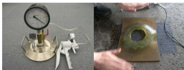
写真-3 現場透気試験機 写真-4 透気漏れ防止材
