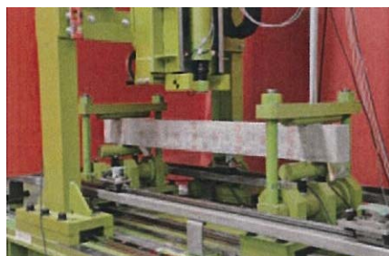
写真-4 衝撃荷重載荷実験の状況
