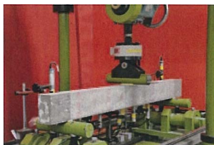
写真-3 静的荷重載荷実験の状況
