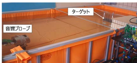
図-8 試験水槽における試験状況
