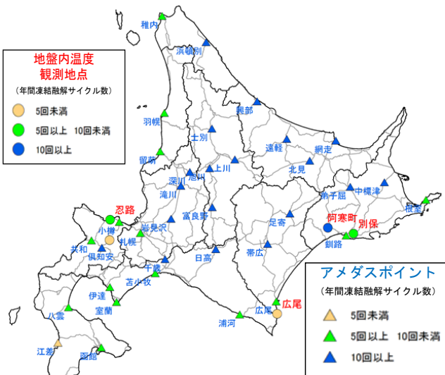
図-3.4 試算した凍結融解サイクル数と分布図
