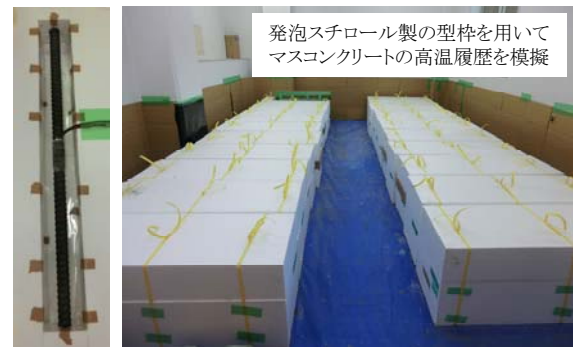
(A)鉄筋拘束試験の実施状況
