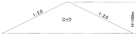
図-2.4 すべり安定解析に用いたモデル
