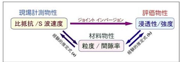
図-5 計測物性からの評価物性推定過程
