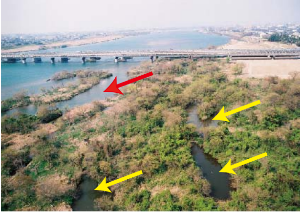
図 - 4 氾濫原水域の例：赤で示されたワンド、黄色で示されたたまり。
