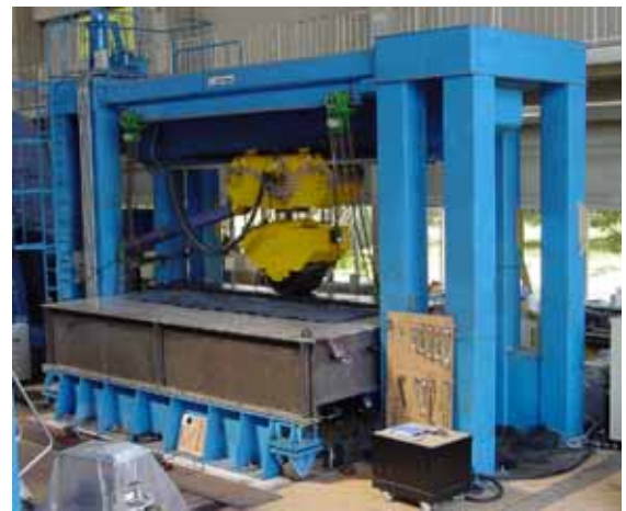
写真 - 1 輪荷重走行試験の状況
