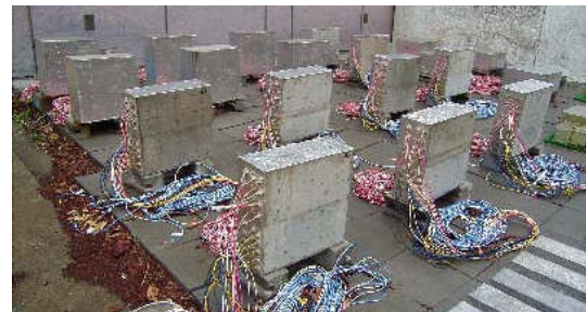
図-3.2.5 屋外暴露状況
