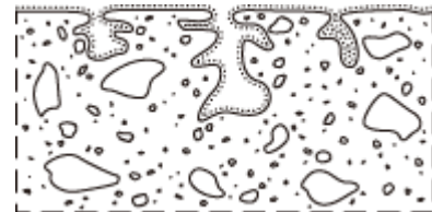
図-3.1.1 シラン系表面含浸材による補修のイメージ 5)
