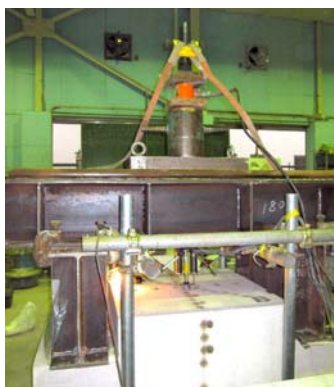
図-4.2.2 引抜き試験の状況
