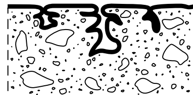
図-3.1.1 シラン系表面含浸材による補修のイメージ 5)
