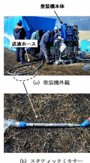
図-3. 1 電子制御混合式塗装機の外観
