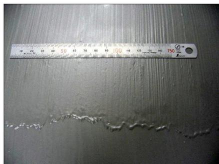
図一. 3. 4 標準用の塗り継ぎ部の凹凸
