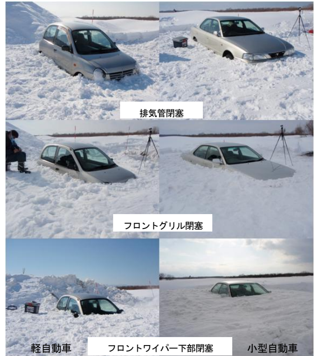
写真-3 実験状況
