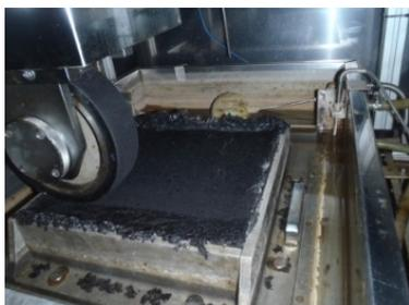
写真-2 水浸ホイールトラッキング試験の試験状況
