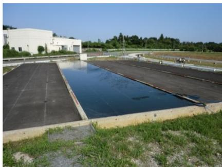
写真-3 モデル路盤と給水状況
