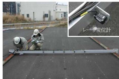
写真-4 膨張量測定状況
