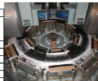
写真-15 氷板回転ラベリング試験状況(試験終了後)
