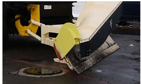
写真-10 右端部装置の衝撃回避動作状況（マンホール蓋縁枠）
