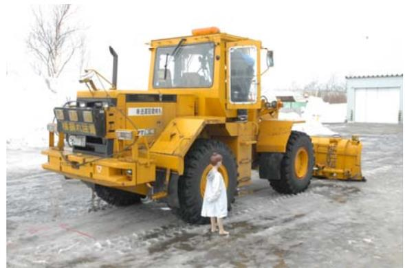
写真-6 死角にいる人の見え方の試験状況
