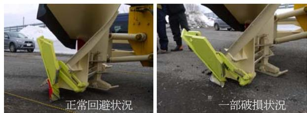
写真-12 左端部装置の一部破損状況
