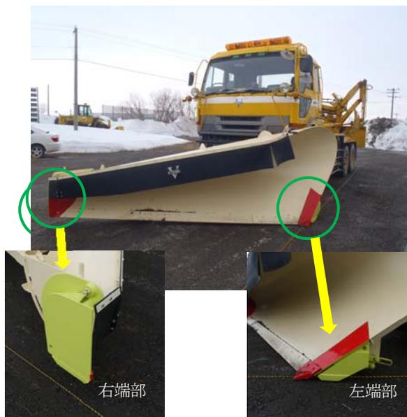
写真-8 試作したIプラウ衝撃緩衝装置
