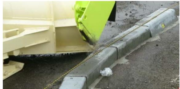
写真-9 右端部装置の衝撃回避動作状況（縁石）
