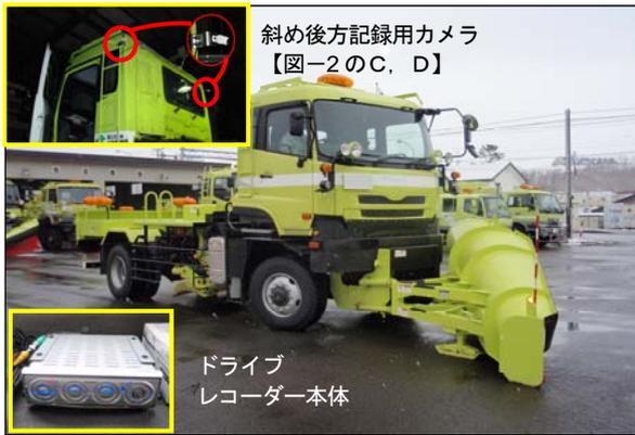
写真-3 ドライブレコーダー装着車（同型車）
