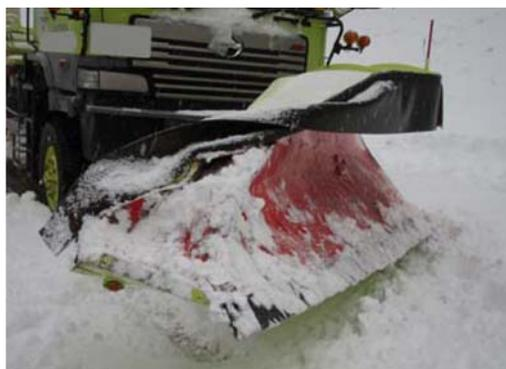
写真-2 事故による除雪車の損傷状況
