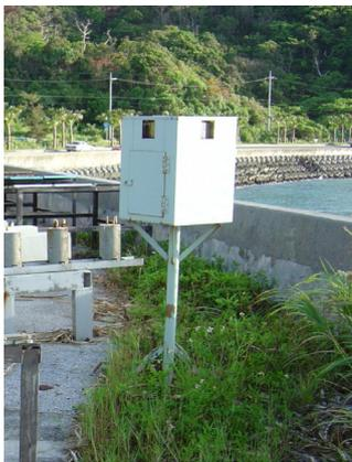
図 3-8 土研式飛来塩分捕集器（沖縄建設材料耐久性試験施設）
