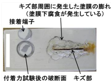
図4-3 サイクル腐食試験における塗膜の劣化評価の例
