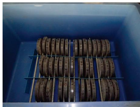
図 2-4 浸せき試験時の試験片設置状況
