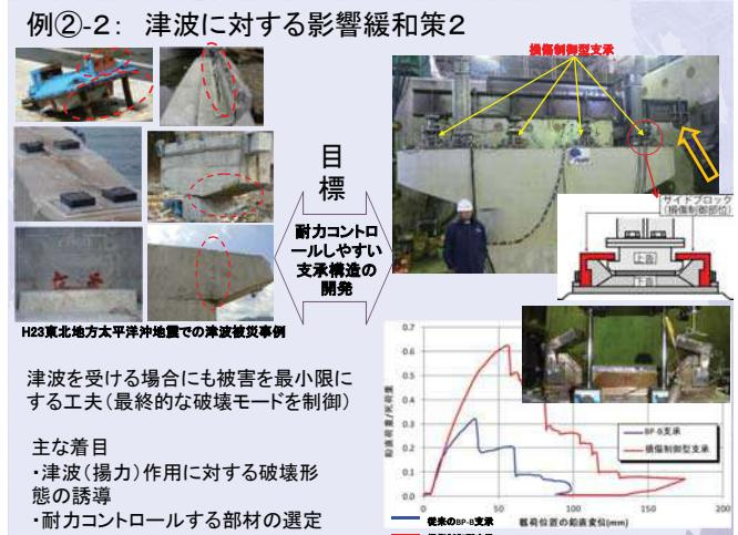
津波を受ける場合にも被害を最小限にする工夫(最終的な破壊モードを制御)
