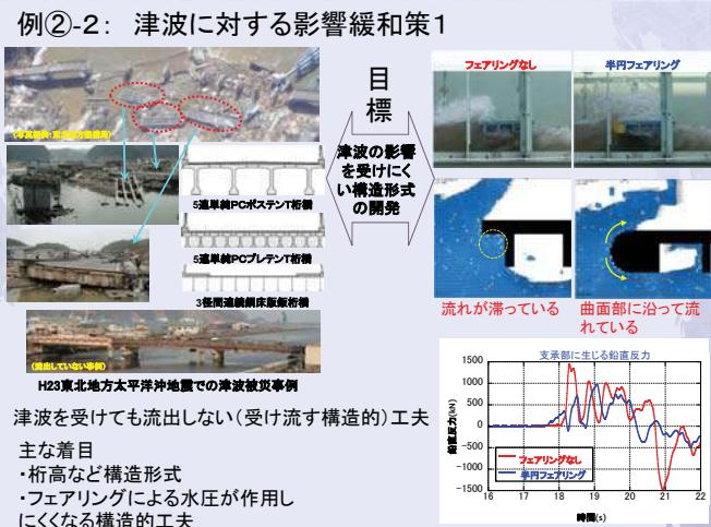
津波を受けても流出しない(受け流す構造的)工夫
