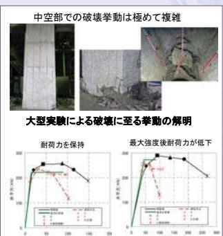
高軸圧下にある中空橋脚の破壊位置と形態を既往の知見で信頼性の高い条件に限定
