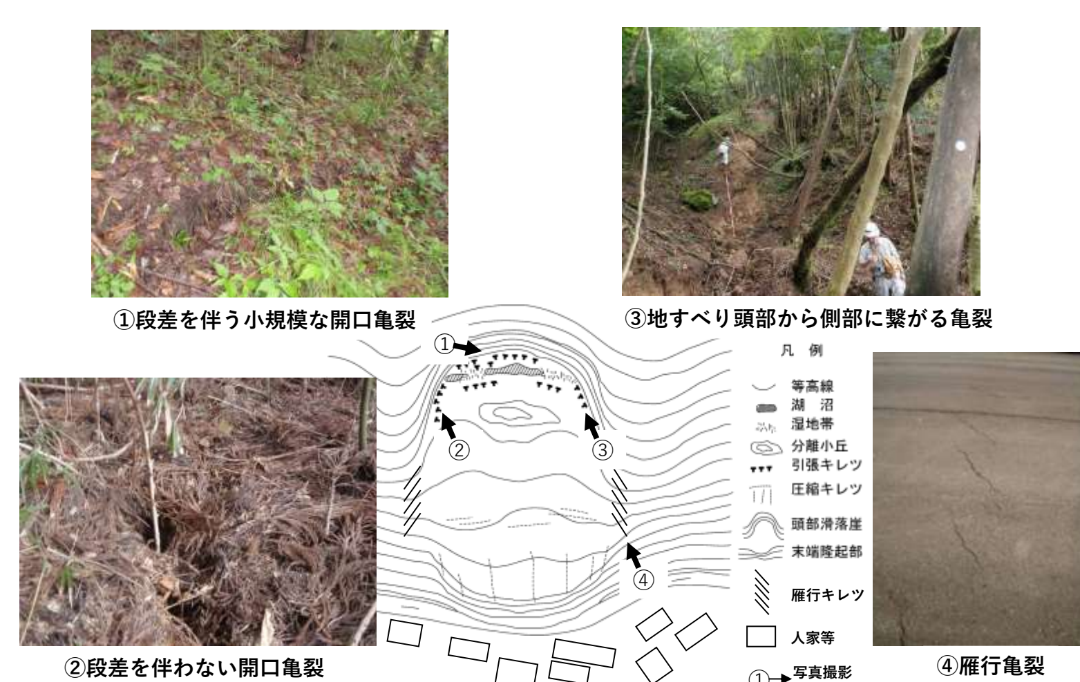
地形図と写真を用いた現地調査結果の整理例
