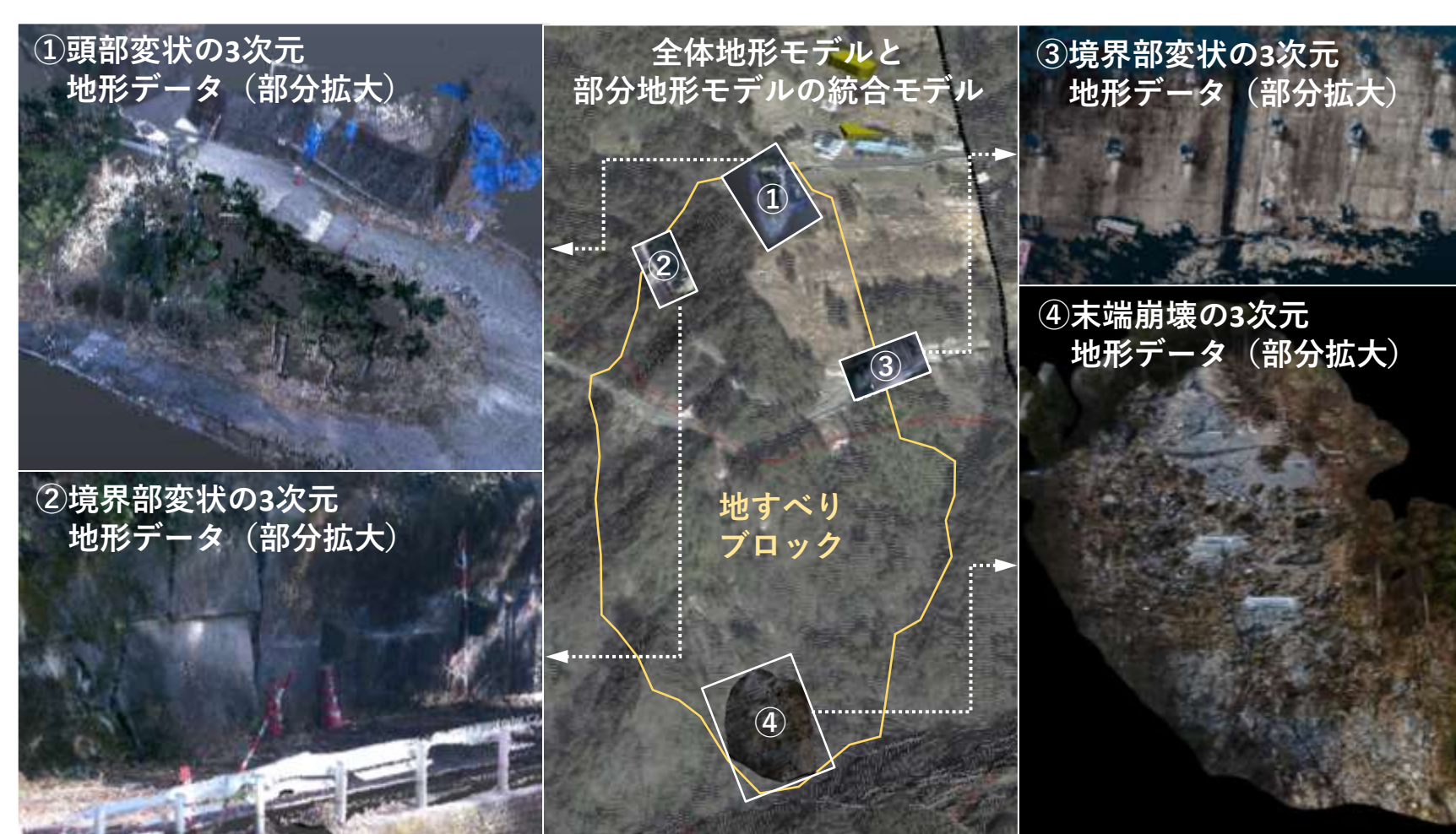
3次元地形モデルを用いた現地調査結果の整理例
