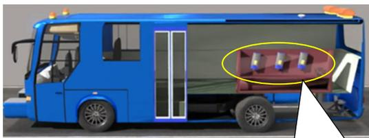
路面がたわむ時に発生する「たわみ速度」を測定するドップラ振動計を搭載
