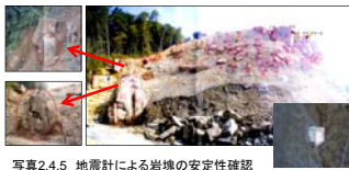
写真2.4.5 地震計による岩塊の安定性確認
