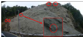
写真2.4.5 地震計による岩塊の安定性確認
