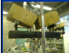
曲げ強度試験状況
