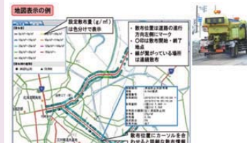
サーバに収集された散布設定情報に基づき作成した地図表示の例
