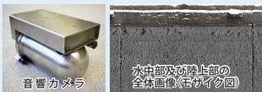
港湾及び漁港施設における水中構造物の健全度診断は有効な点検手法が確立されておらず、潜水士の目視観察に頼っているのが現状であり、効率的な点検手法が求められています。
