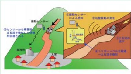
本センサーは、流下する土砂等の振動波形を測定し、土石流の発生をリアルタイムで検知するものです。従来のワイヤーセンサーと比べて、連続して土石流を検知できること、設置に際して河床に立ち入る必要がなく、作業時の安全性が確保できること、観測した振動
