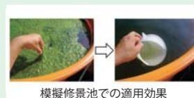
下水処理水は、窒素やリン等の栄養塩類を比較的高濃度を含むことが多く、都市内の水路や池に修景利用した場合、藻類が大量に発生する事例が報告され問題となっています。本技術は、担体(短いストロー状のもの)の表面に自然に発生する微生物により、下水処理水の微量金属(主にマンガ)濃度を低下させて藻類の増殖を抑制するものです。従来の凝集剤や逆浸透膜などによる処理方法に比べて簡易なものであり、さらに魚類雌性化等が懸念されるエストロゲン(女性ホルモン)の濃度も低下させることができます。
