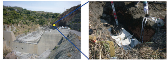
溪岸に振動を観測できるセンサーを設置する。土石流が発生する地盤振動をとらえて検知する。
