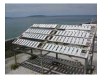
耐食試験の設置状況
