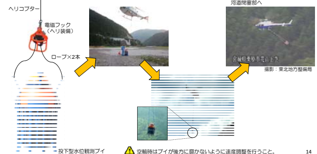
⚠️ 空輸時はバイが後方に靡かないように速度調整を行うこと。
