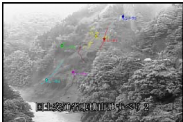
岐阜県東横山地すべりにおける2次元ビデオ映像を用いた移動ベクトル解析(PTV)
