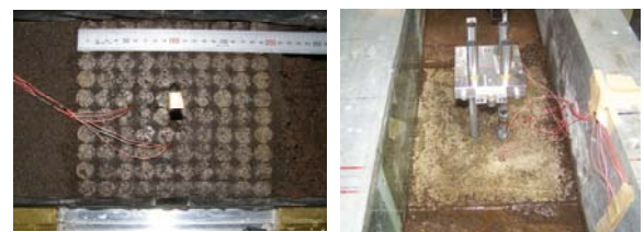
レベル2加振後の状況 = 健全
